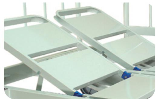
El lecho está construido en 4 planos de chapa con perímetros de acero y esquinas redondeadas. Al no tener puntas con filos se protege al operador de la cama, la parte central está soldada a la estructura y el resto vinculados entre sí por medio de pernos de acero con cabeza especialmente redondeada para su mejor acabado.
